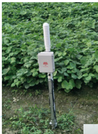
旱田感測器即時監控確認土壤的最低濕潤度。
