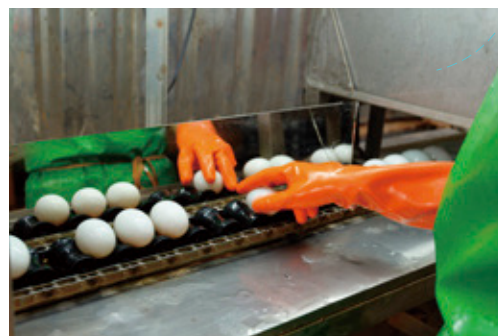
蛋品潔淨機品檢臺設置鏡面，讓工作人員輕鬆透過鏡面檢視蛋品裂痕瑕疵。
