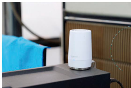
溫室導入智慧化監測設備，不同溫室的環境數據會收集至此收集器。
