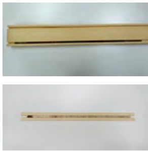
▲圖 2 樹芯試材埋置木台並切成掃描試片
