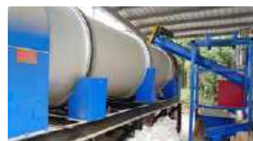
▲圖三 本技術採用之原料乾燥設備
