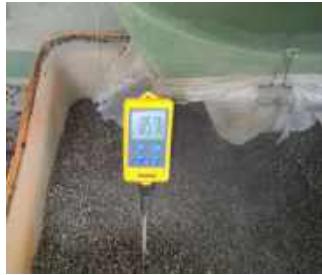
▲製粒程序之溫度達 85°C 以上，可有效殺死大腸桿菌、沙門氏菌及線蟲
